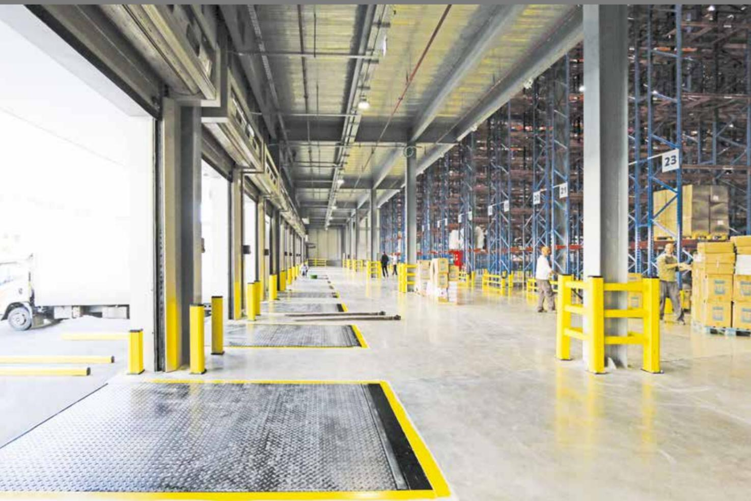
Предназначены для предотвращения доступа к воротам или большим дверям больших транспортных средств или же просто для маркировки зон ограниченного доступа для пешеходов. Система поставляется с полным комплектом крепежных элементов.
